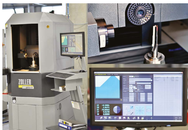
MERACIE ZARIADENIE ZOLLER - KONTROLA GEOMETRIE A OPOTREBOVANIA REZNÝCH NÁSTROJOV
