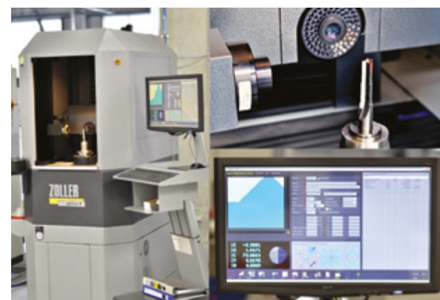
MERACIE ZARIADENIE ZOLLER - KONTROLA GEOMETRIE A OPOTREBOVANIA REZNÝCH NÁSTROJOV
